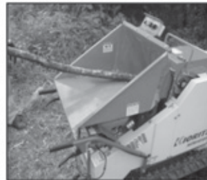
▲ 動力粉碎機 (左は木を入れ込む様子) (右は木がチップになって出てくる様子)
