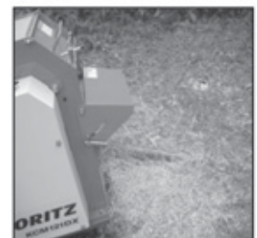
▲ 動力粉碎機 (左は木を入れ込む様子) (右は木がチップになって出てくる様子)
